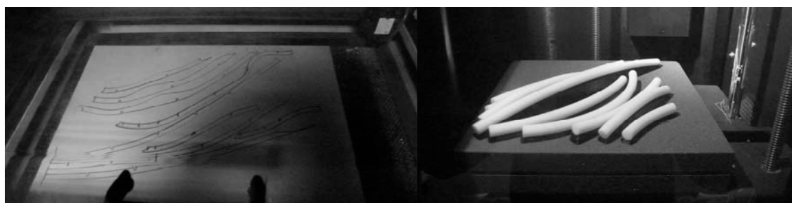
圖 5-77 實物模型製作過程: 雷射切割及 RP 輸出骨架單元
