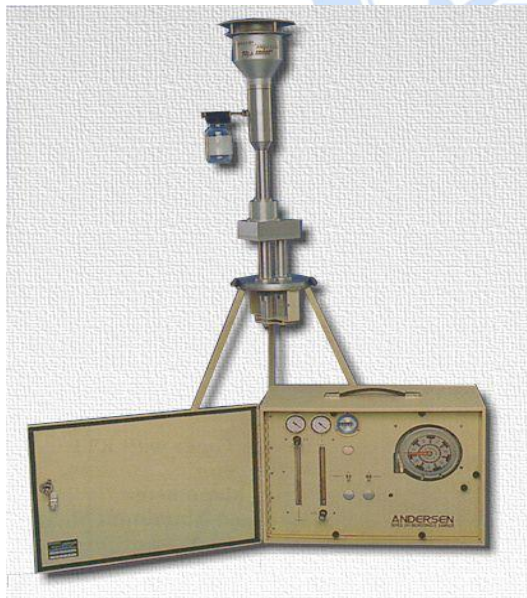
圖 2.2 雙通道 PM_{10-2.5} 及 PM_{2.5} 採樣器實體照片及虛擬衝擊器結構圖。
