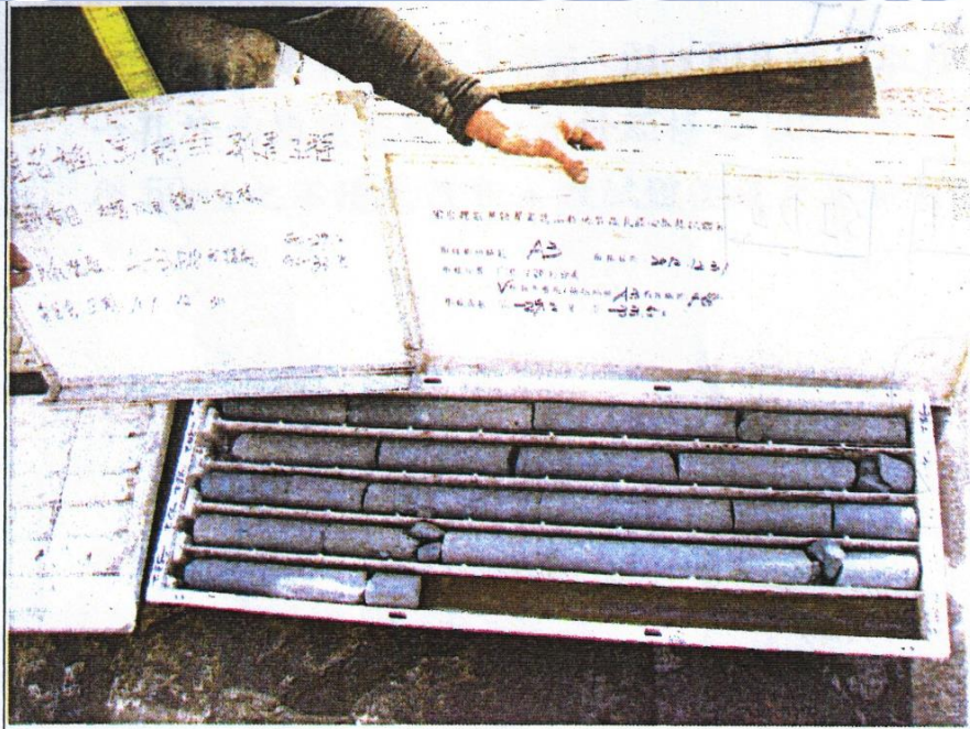
b. 樁號 A3 之改良鑽心取樣
