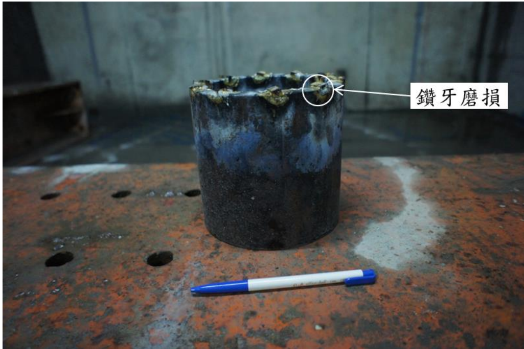
圖 4.12 鑽頭之鑽牙遭磨損
