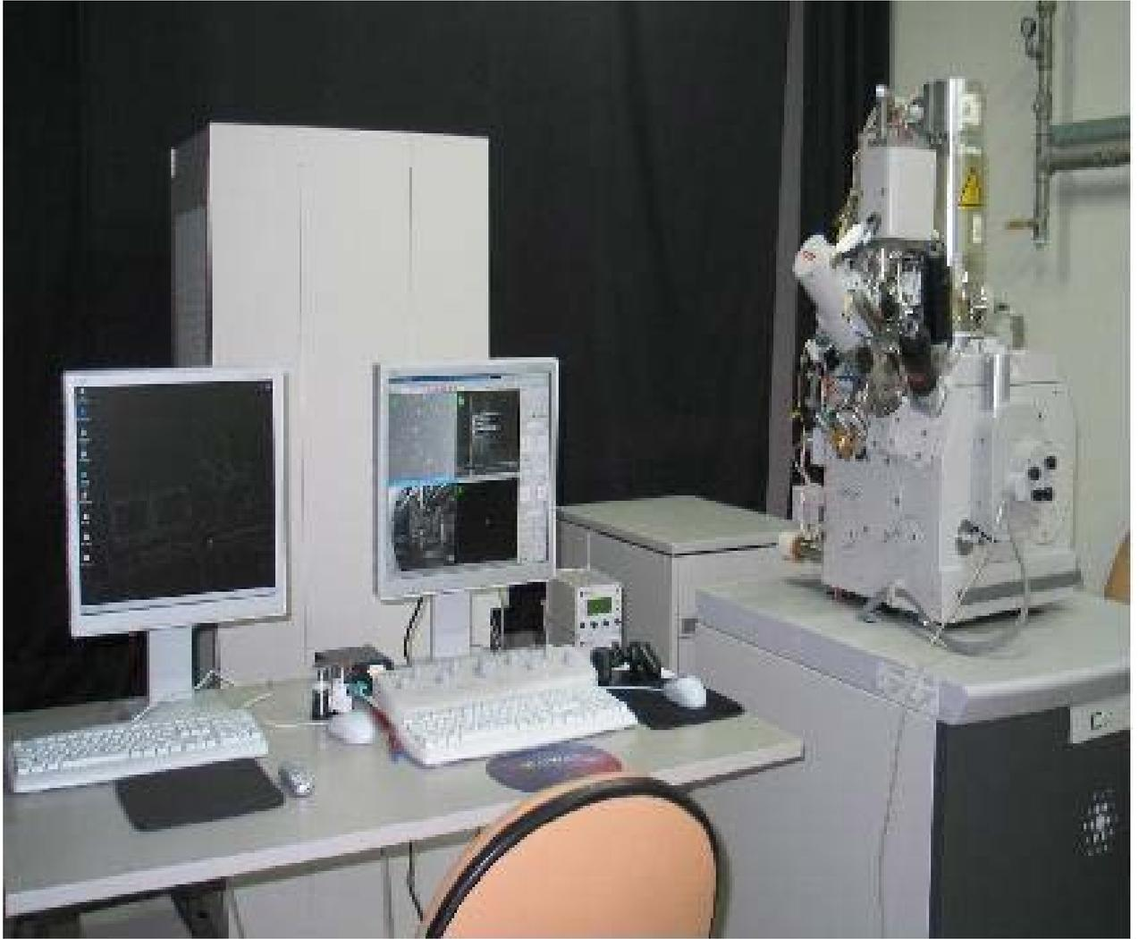
圖 39 聚焦離子顯微鏡儀器圖
