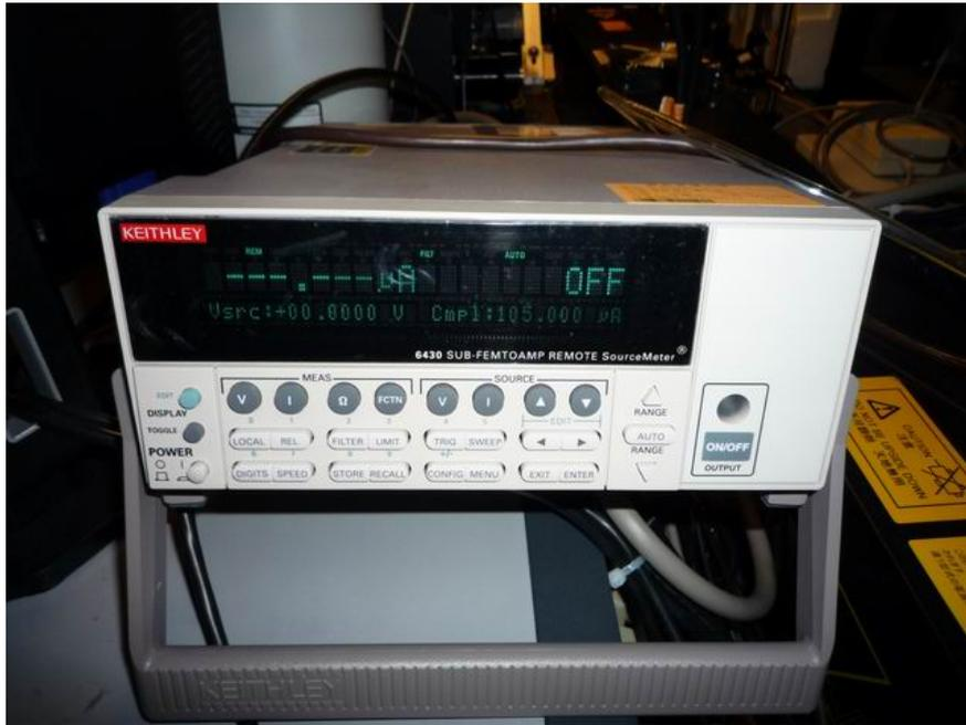
圖 44 Keithley 6430 Sub-Femtoamp Remote Source Meter
