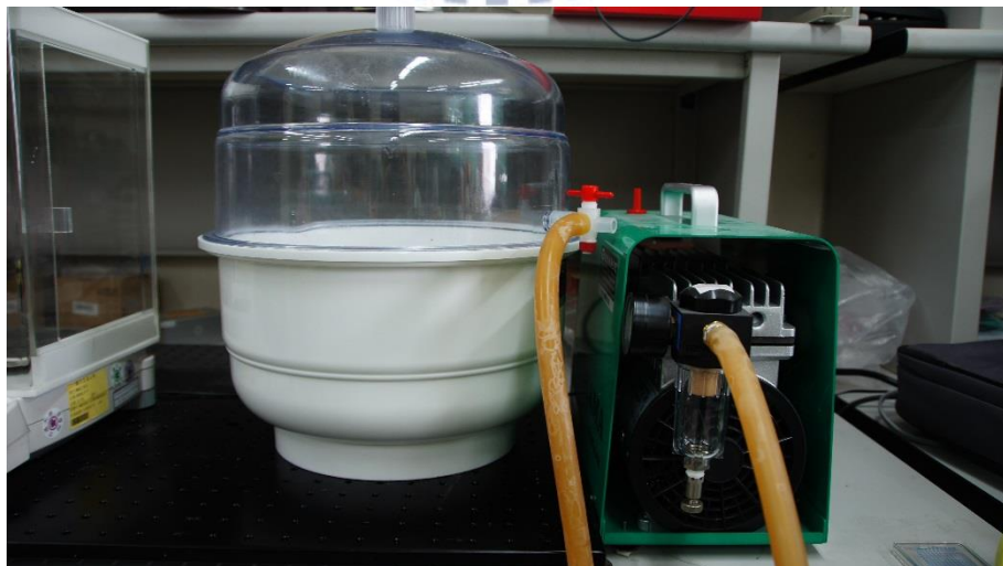
圖 3.27 抽真空所用壓縮機與壓力鍋
