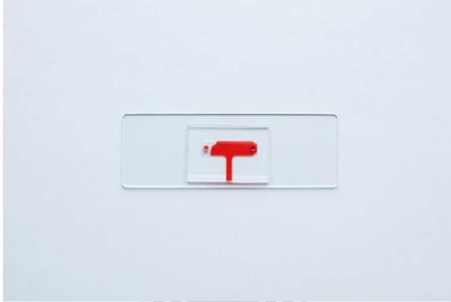
圖 3.32 PDMS-T 型試片加入全血血液樣本示意圖
