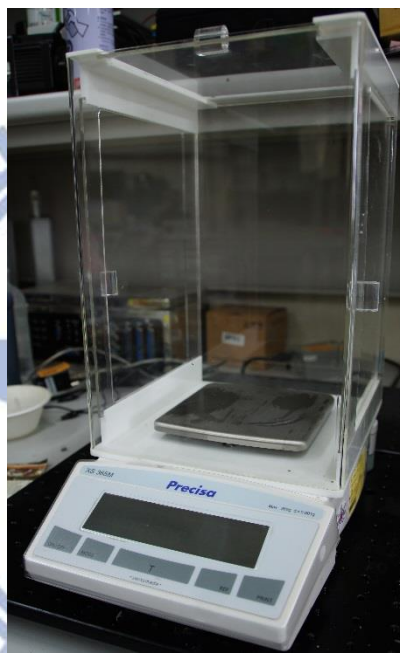
圖 3.26 精密電子天秤 (精度至 mg)
