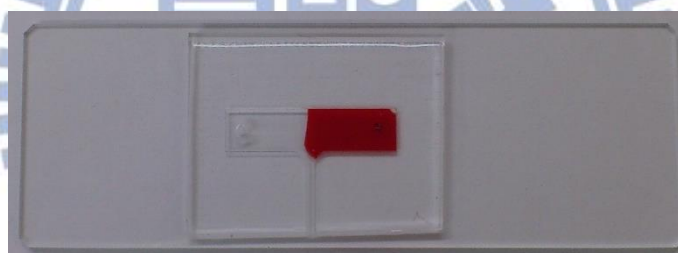
圖 4.33 全血注入 PDMS-T 型試片
