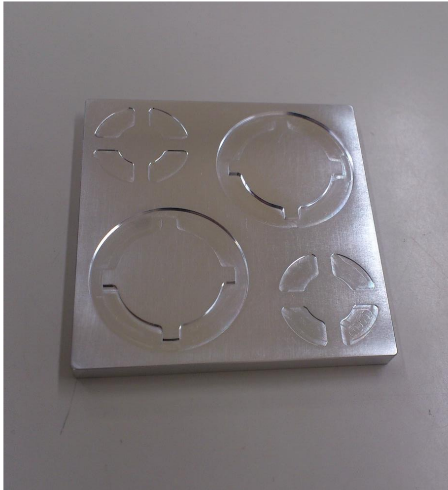
圖 3.35 PDMS-圓型試片母模
