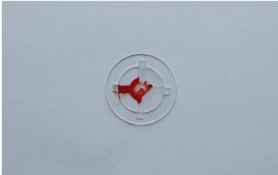
圖 3.37 PDMS-圓型試片加入全血血液樣本示意圖
