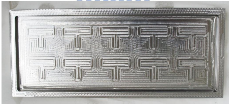
圖 3.30 PDMS-T 型試片母模
