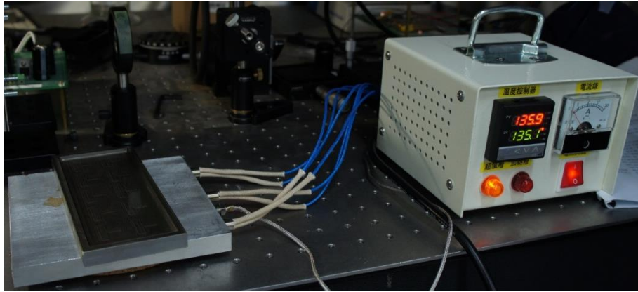
圖 3.25 加熱基板與加熱器
