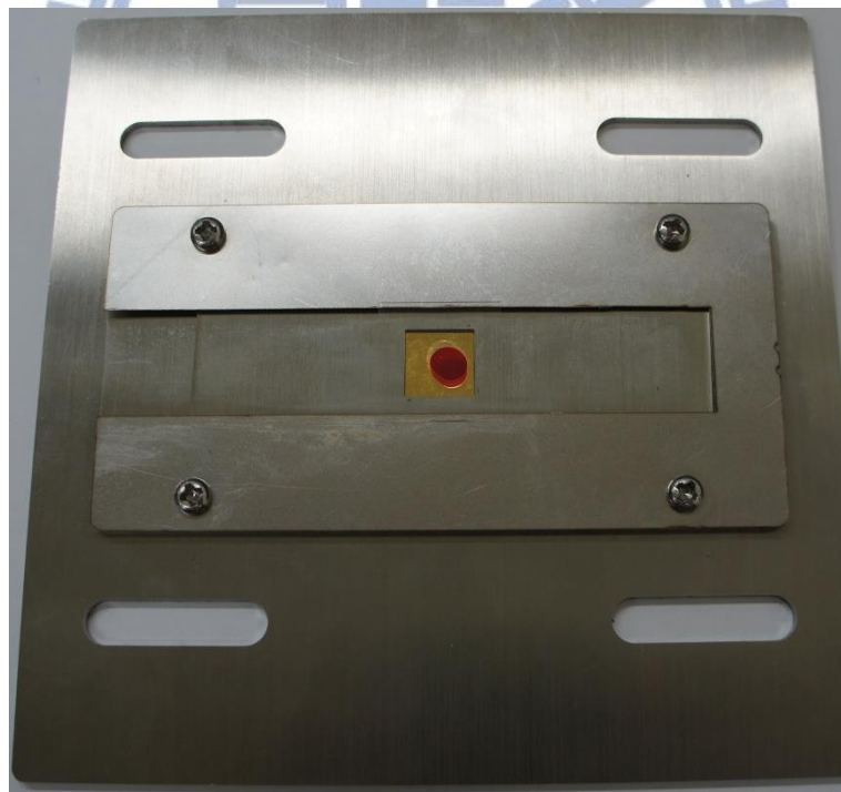
圖 3.23 載玻片-蓋玻片乘載血液樣本
