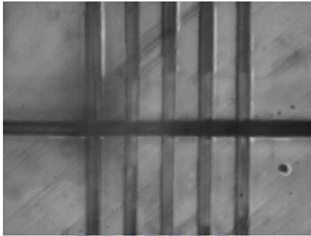
圖 3-3-2、氧化鋅奈米柱與微流道 OM 圖。
