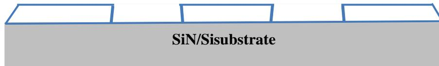
圖 3.4 顯影完之後光阻在基板上形成保護區與非保護區側面示意圖。
