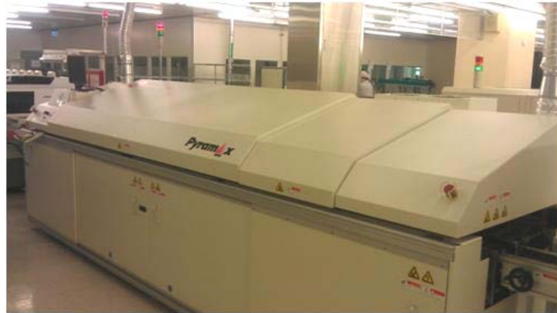
Fig. 3-13 BTU IR reflow oven
