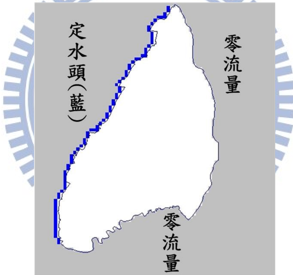
圖 5.1-5 濁水溪沖積扇模式第 1 分層格網劃分
