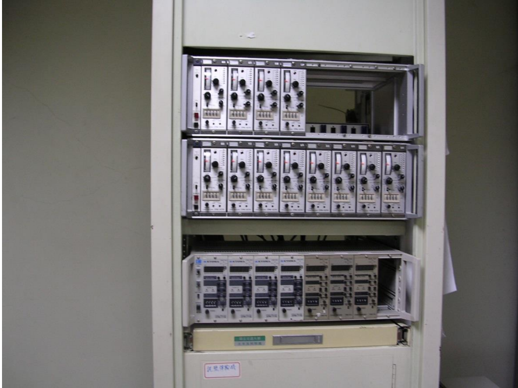
圖 3-19 動態應變放大器(Kyowa DPM-711B)
