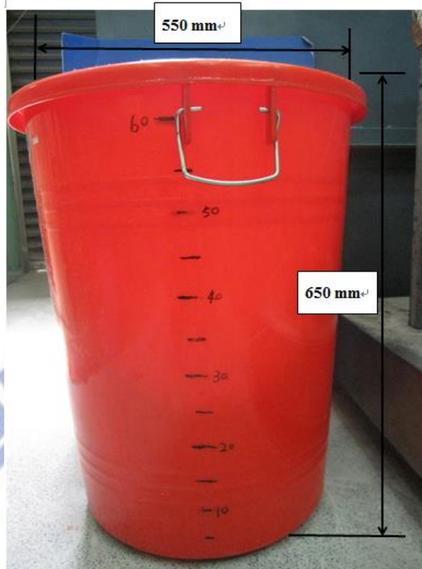
圖 4-11 桶徑 550 mm 之大試驗桶
