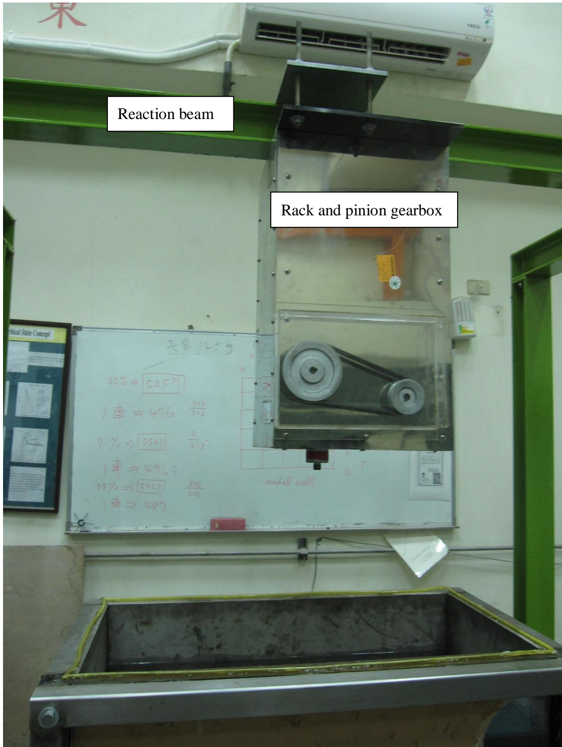
圖 3-14 機械式馬達齒輪箱
