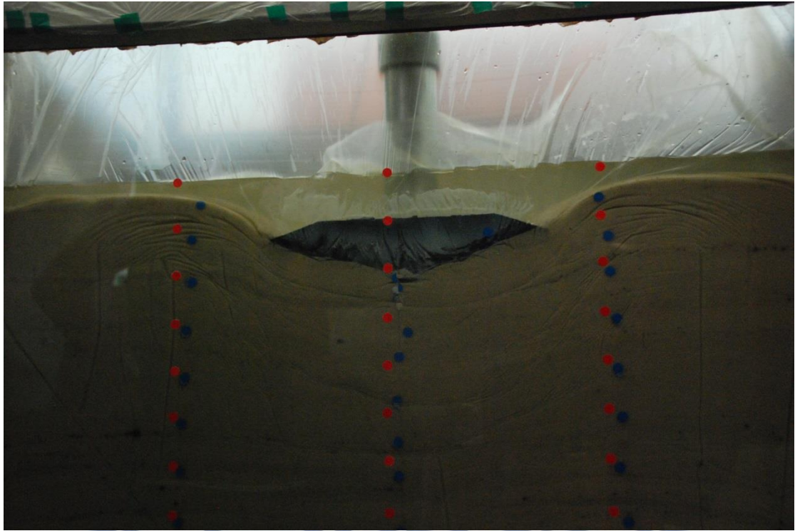
圖 5-21 spudcan 貫入達 100 mm
