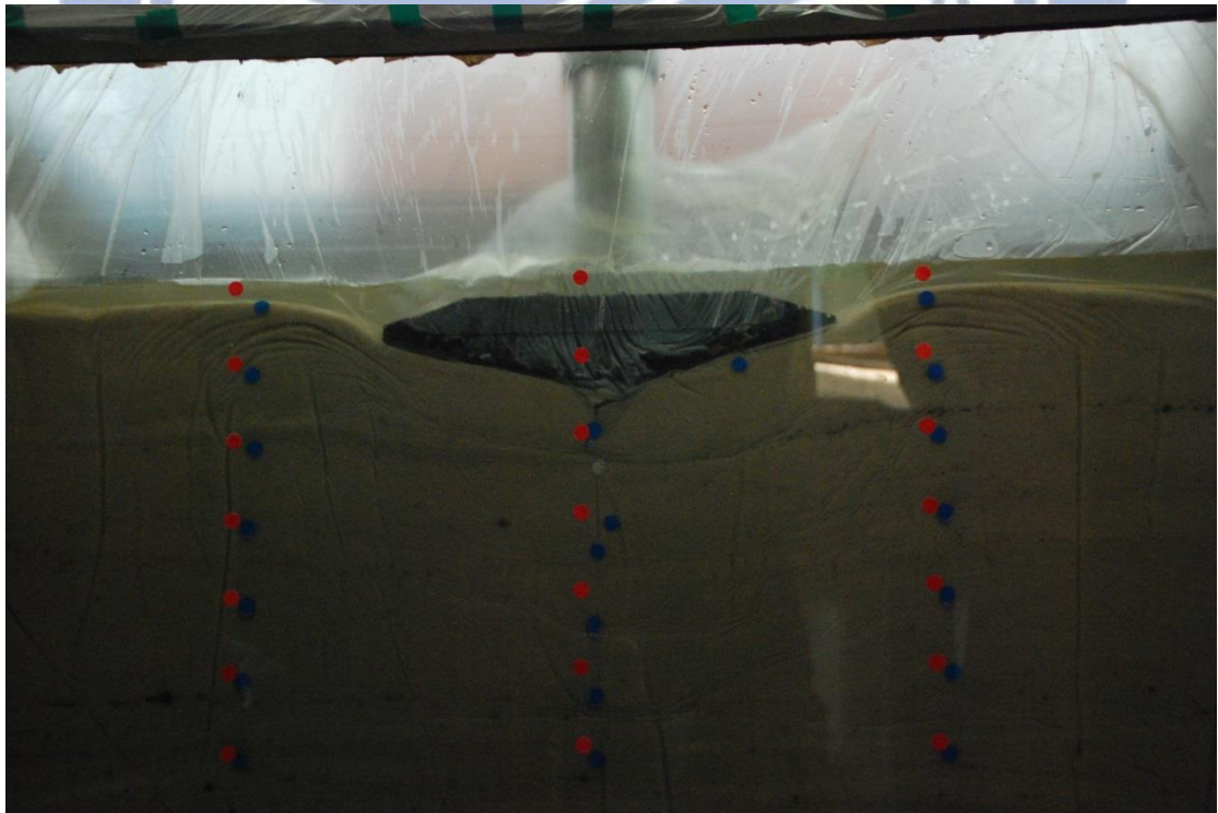
圖 5-20(b) spudcan 貫入達 50 mm
