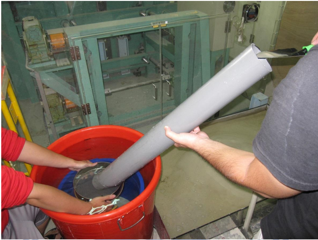
圖 4-17 砂土經 PVC 管滑入篩網
