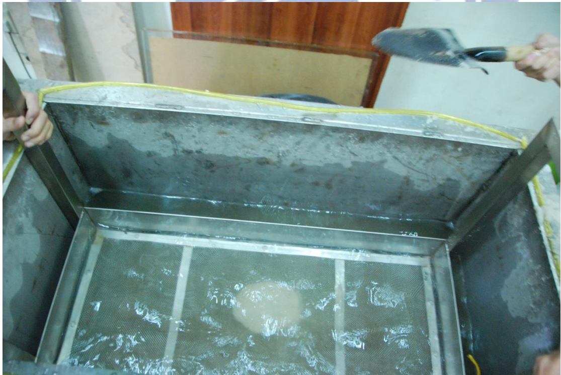
圖 5-16(a) 長方形篩網進行水中實降法
