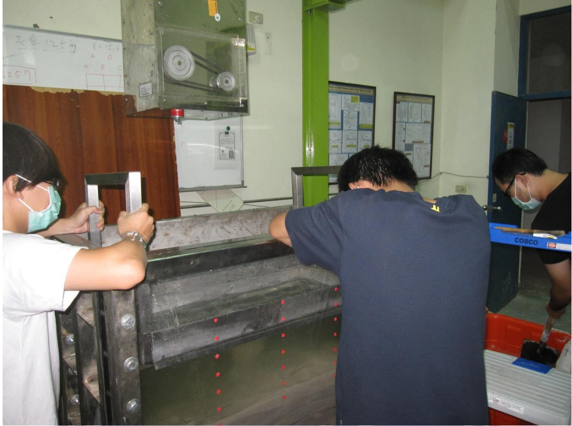
圖 5-15(b) 水中實降法示意圖
