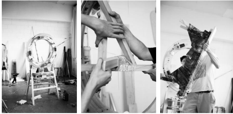
Fig 2-20 捆繩機接合法與其接合細部
