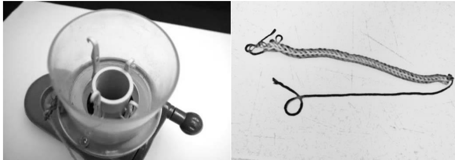
Fig 3-13 (A)手搖編織機的筒狀加工平台 (B)編織機所生產之編織物
