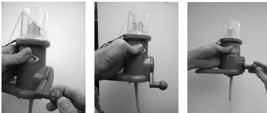
Fig 3-12 手搖繩索編織機之運作與產出之編織物
