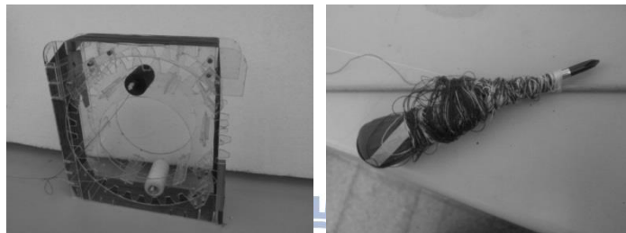
Fig 3-9 (A)捆繩機實驗機具 (B)實體施作成品
