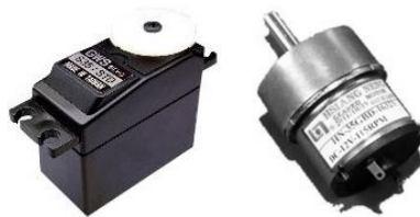
Fig 3-22 (A) 伺服馬達 (B) 強扭力直流減速馬達
