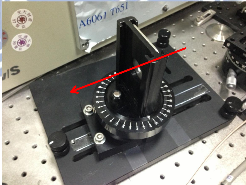
圖 18 穿透率量測模組，紅色箭頭為光行進方向
