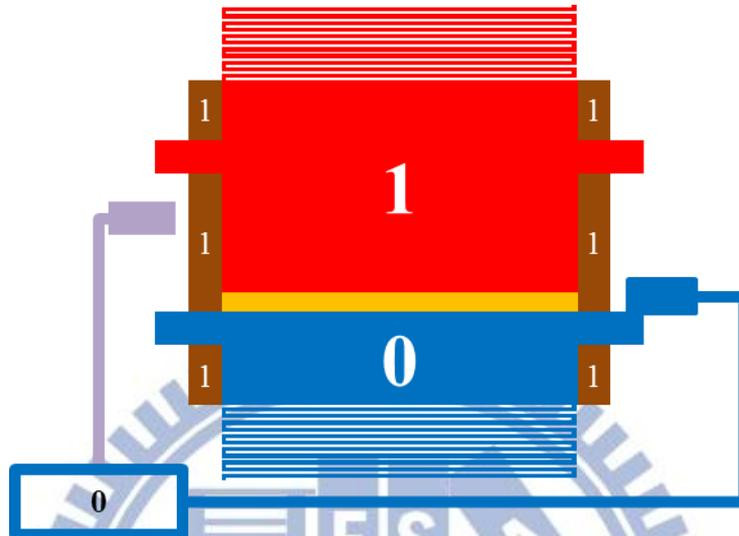
圖 3.9 梳狀結構制動器微機電邏輯閘，輸入  $(A, B)$  為  $(1, 1)$
