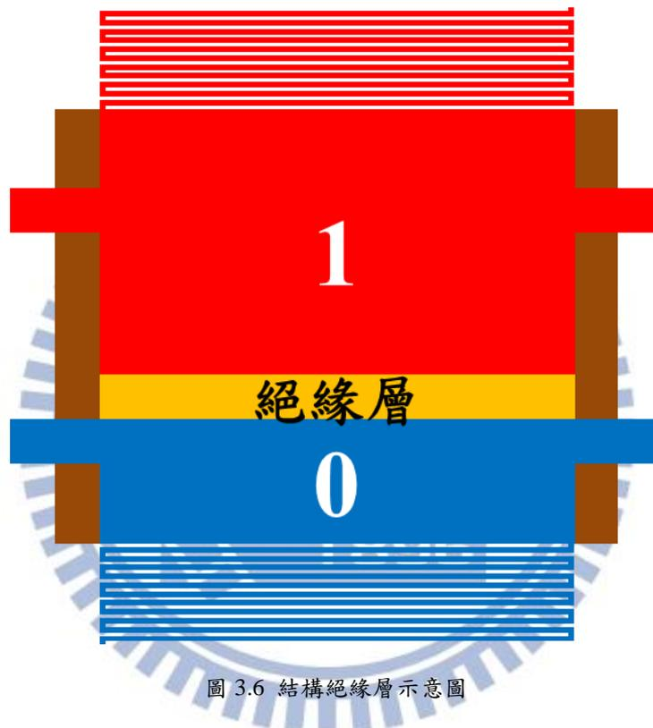
圖 3.6 結構絕緣層示意圖
