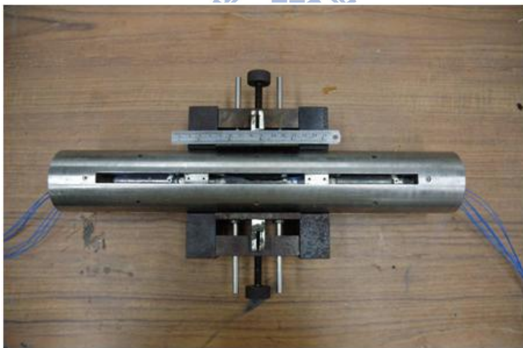
圖 3.12 傍壓儀簧片標定試驗圖
