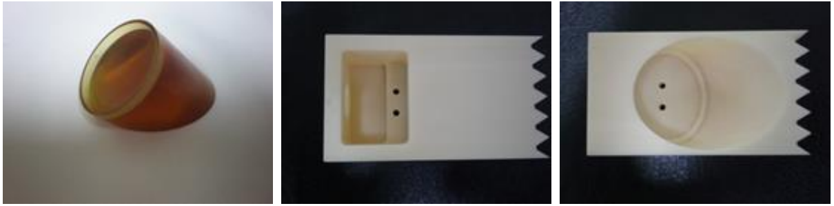
圖4.1 超音波流量計探頭實體之(左)斜柱波導及外殼的(中)上視、(右)下視照片
