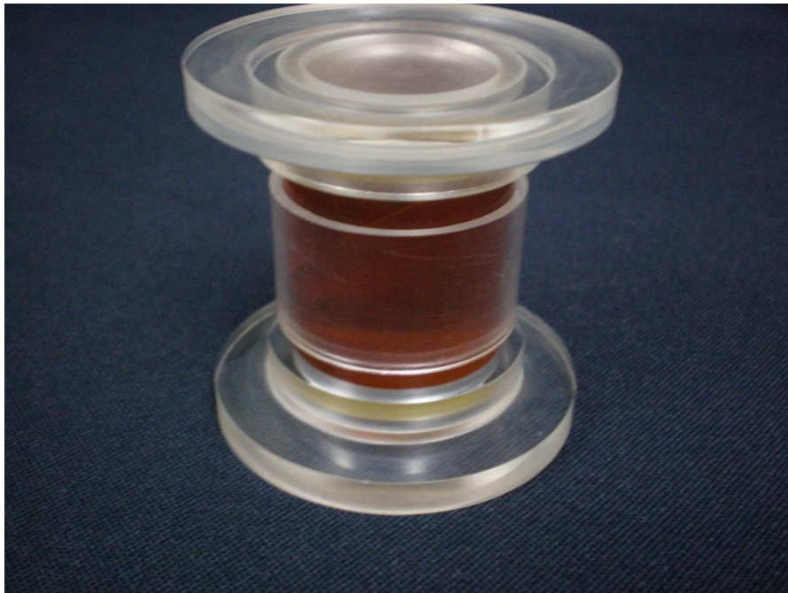
圖4.2 輔以夾具黏貼壓電片
