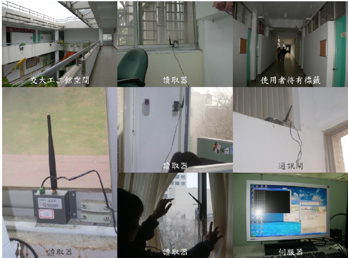
圖 24 RFID 空間移動追蹤實況照片
