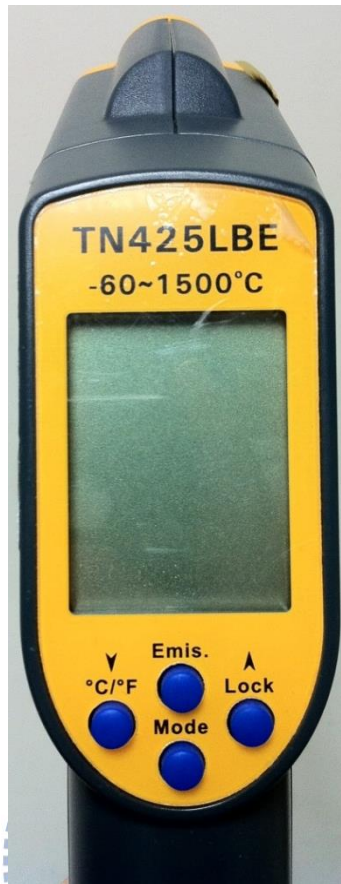
圖 4.10 ZyTemp TN425LBE 紅外線溫度計
