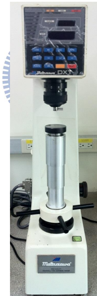
圖 4.7 Matsuzawa DXT-3 洛克式硬度測試
