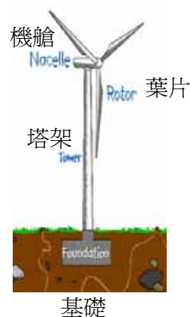
圖 3-4 風力發電機系統架構圖
