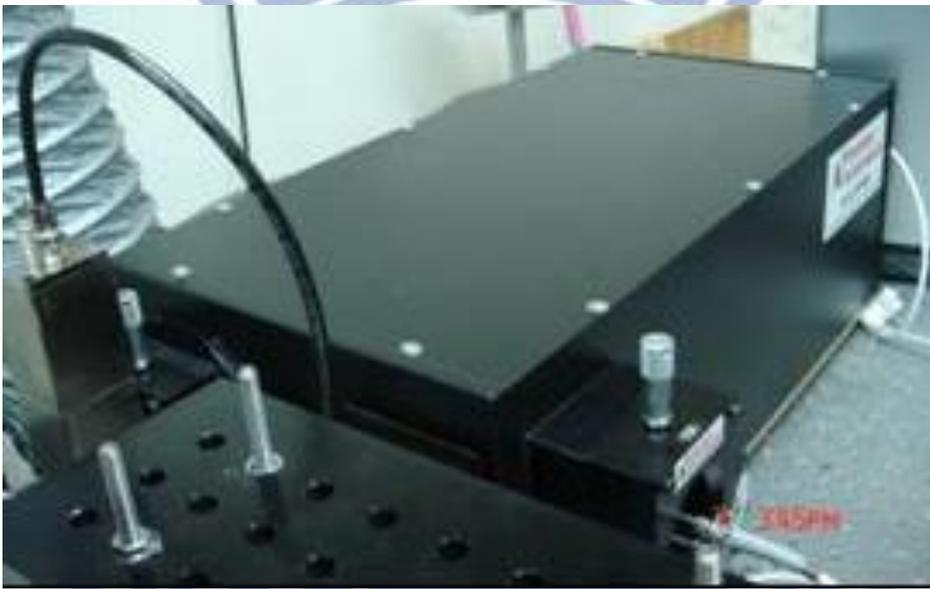
圖2.9 光譜儀(Optical Emission Spectroscopy,OES) , 型號為 PI Acton SP 2500。
