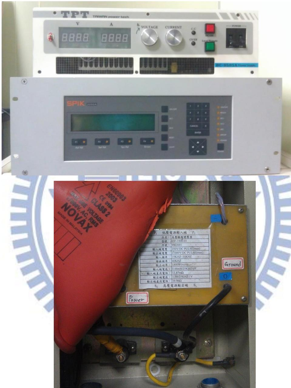
圖2.4 Sine wave DC pulse 電源供應器由電源供應器、脈衝電源控制器 (SPIK2000A)和高壓脈衝變壓器(HV-1500-03)頻率操作範圍 15 到 35 kHz(由上而下。)
