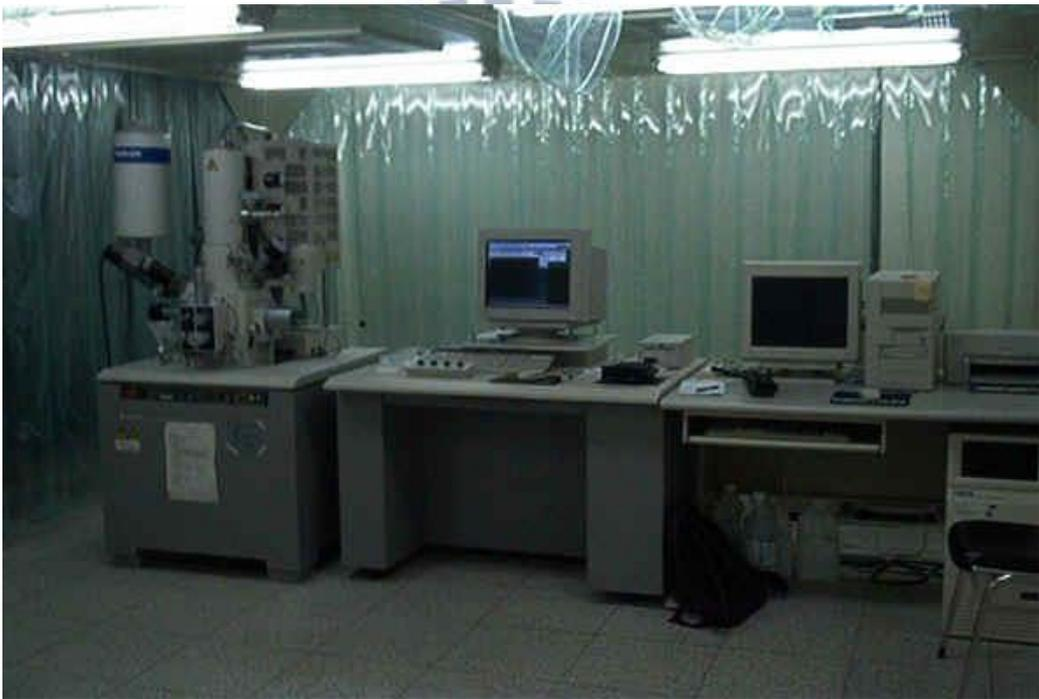
圖2.11 場發射掃描電子顯微鏡(SEM)，使用的型號為 Hitachi S-4700I，操作電壓為 0.5kV~30kV，解析度為  $15\text{\AA}$ 。
