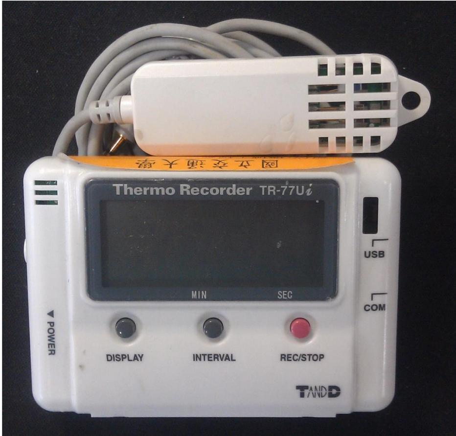
圖2.8 濕度量測器是 Thermo Recorder 型號為 TR-77Ui 靜電電容式的感測器。
