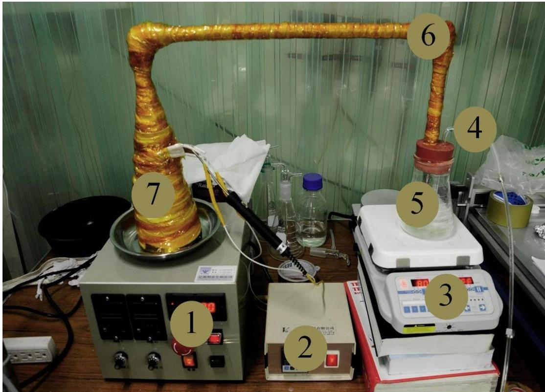
圖2.1 成形 honeycomb-pattern 的設備圖(圖上標示為組件 1 到 7), 分為蒸氣系統和加熱系統。
