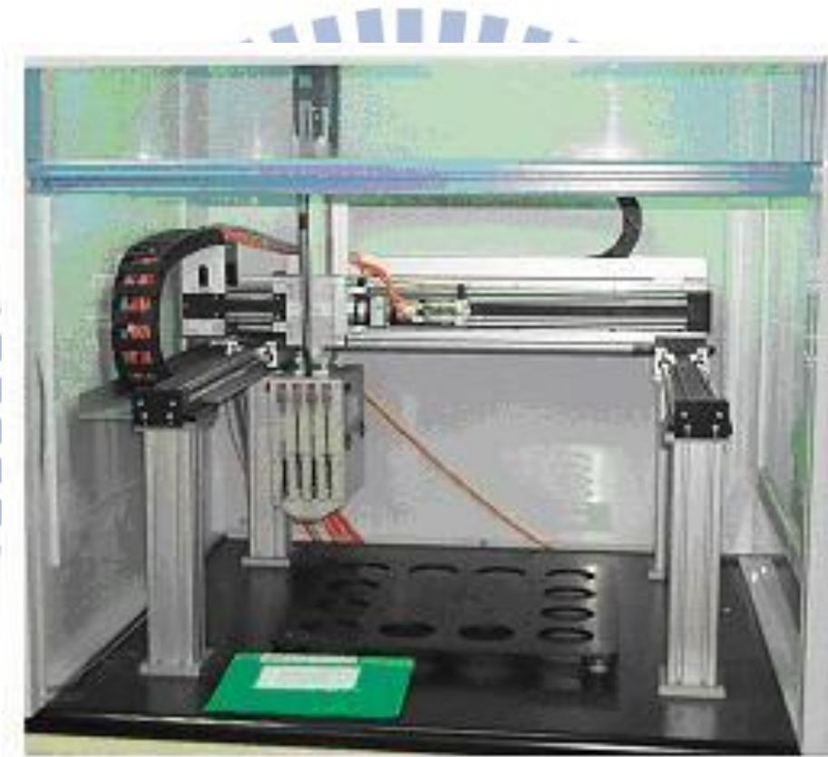
圖2.10 水滴接觸角量測系統(CA)。
