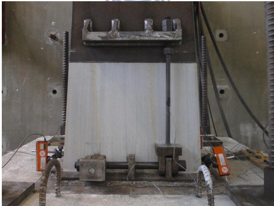
圖 4.26 東北側形狀記憶合金斷裂
