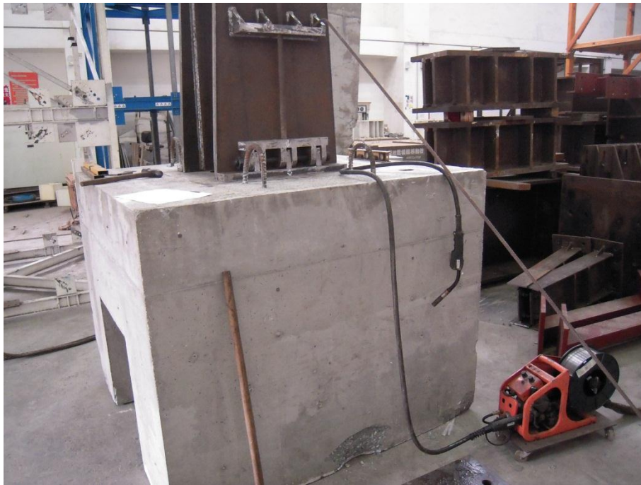
圖 3.18 鋼柱、基礎與形狀記憶合金裝置之鉸接定位
