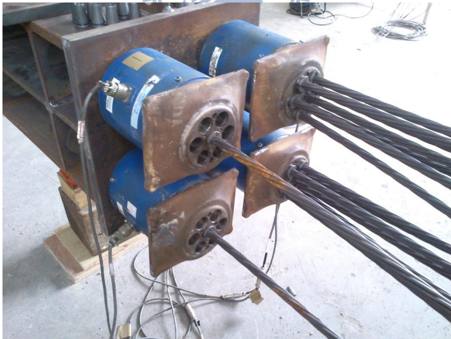
圖 3.21 鋼絞線由中央開始預緊
