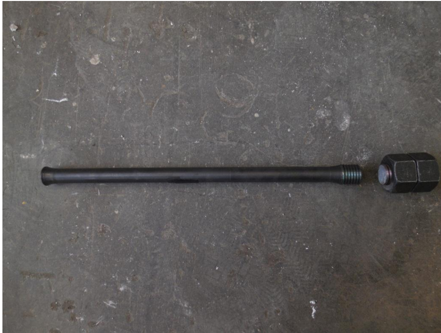
圖 4.27 東北側斷裂之形狀記憶合金
