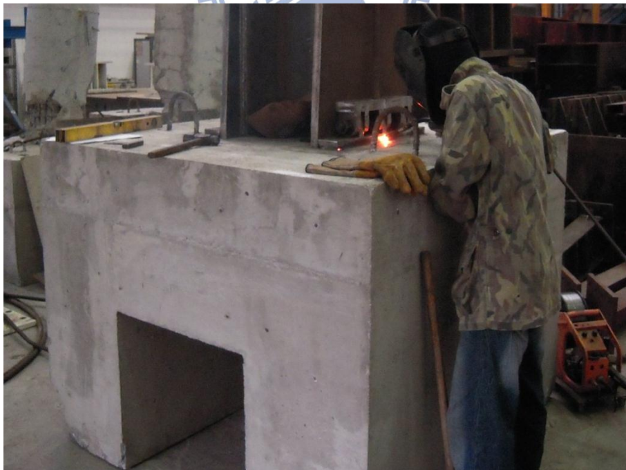
圖 3.19 形狀記憶合金裝置之鉸接點銲固定
