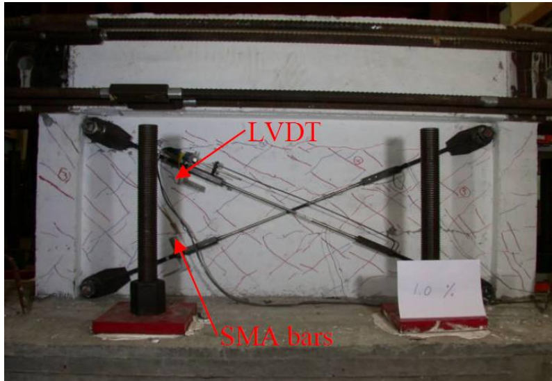
圖 1.9 棒狀形狀記憶合金運用於剪力牆 (Liao et al. 2006)
