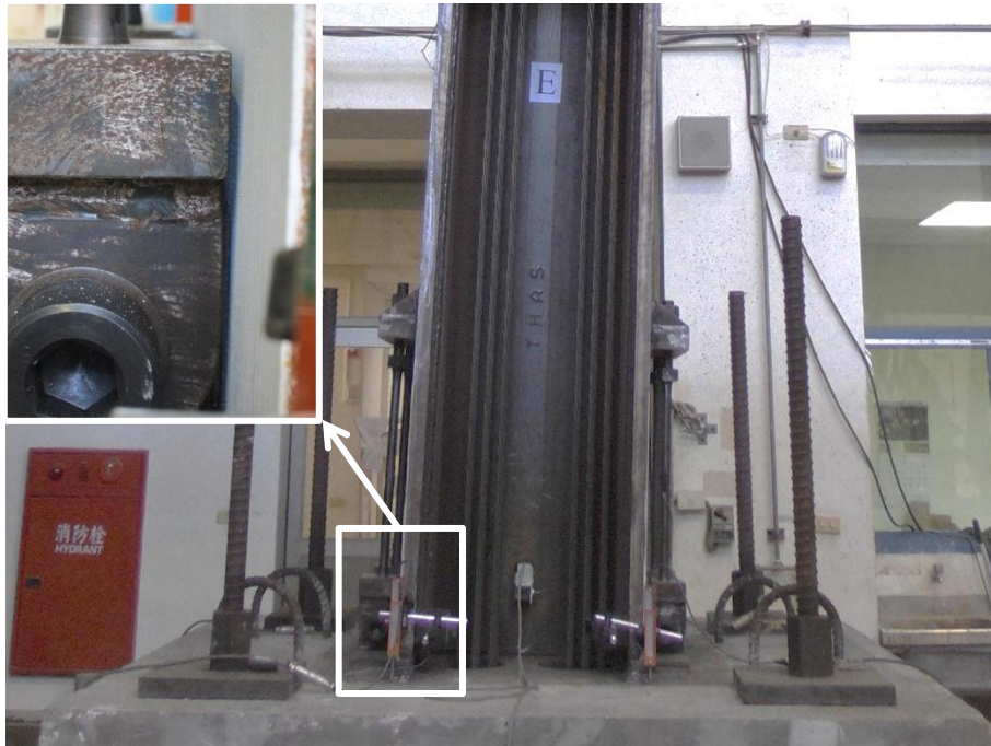
圖 4.18 正迴圈之鉸接旋轉
