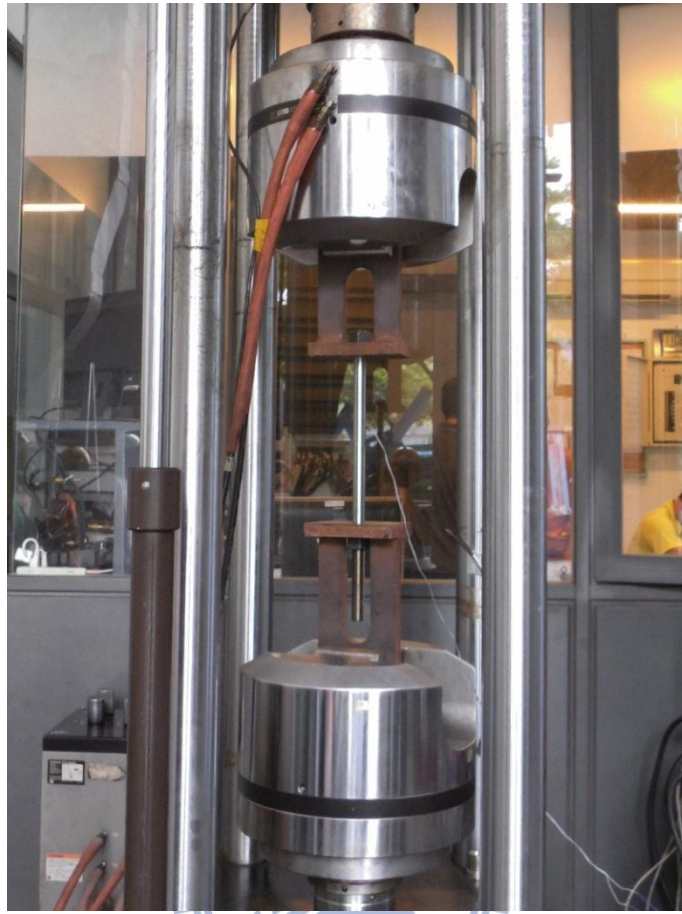
圖 4.1 形狀記憶合金材料試驗設置圖
