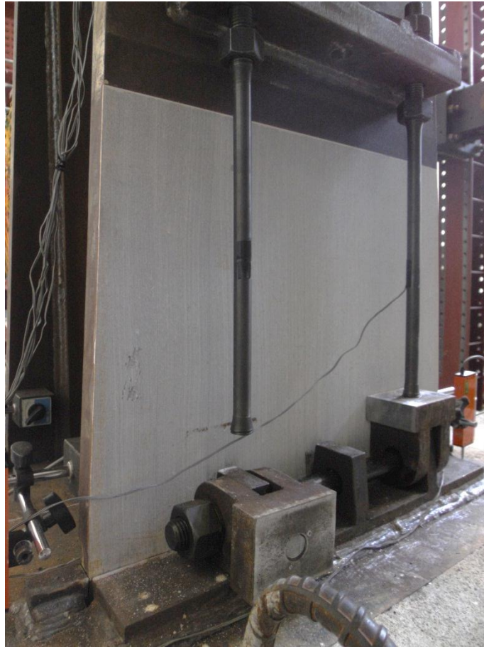
圖 4.25 西南側形狀記憶合金斷裂
