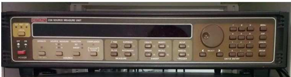
圖 4.16、背景光電流量測系統實照 (a)致冷座，(b)屏蔽盒，(c) Keithley 236 電源-量測單位儀器
