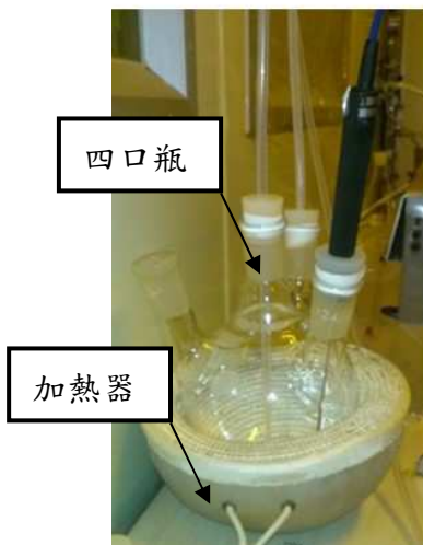
圖 4.6、氣泡式氧化系統實照 (a)爐管，(b)四口瓶與加熱器，(c)冷卻系統
