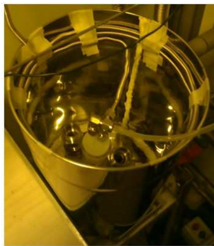
圖 4.6、氣泡式氧化系統實照 (a)爐管，(b)四口瓶與加熱器，(c)冷卻系統
