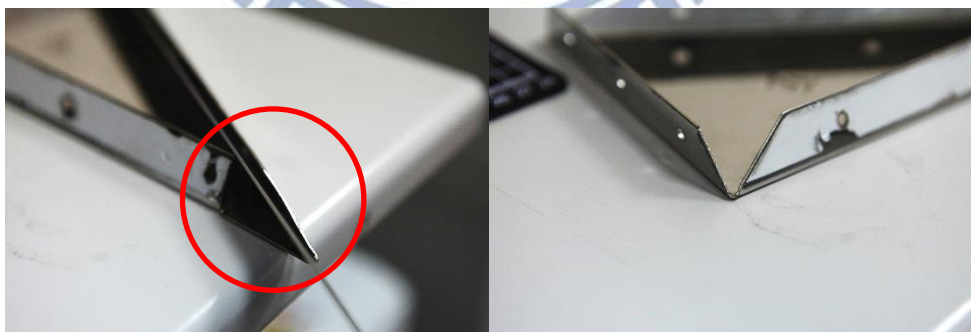
圖 4- 21 銳角情況(已裁切過)、鈍角情況
