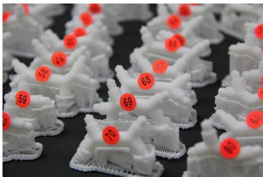
圖 4- 41 在節點上編號、裁切好的管材
