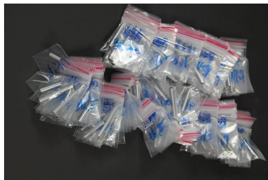
圖 4- 41 在節點上編號、裁切好的管材
