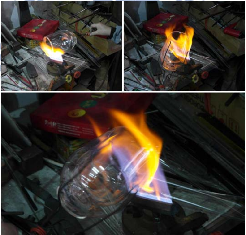
圖 3 -20 雙層玻璃杯製作過程-黏合(本創作拍攝)
