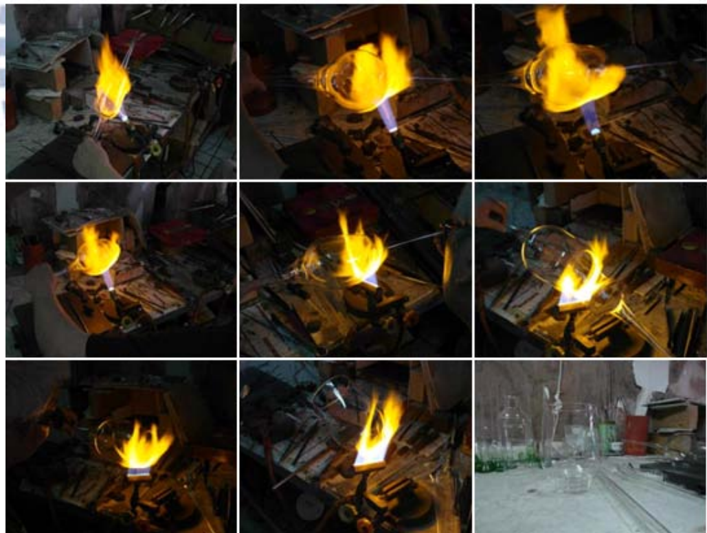
圖 3-18 雙層玻璃杯製作過程-外層(本創作拍攝)
