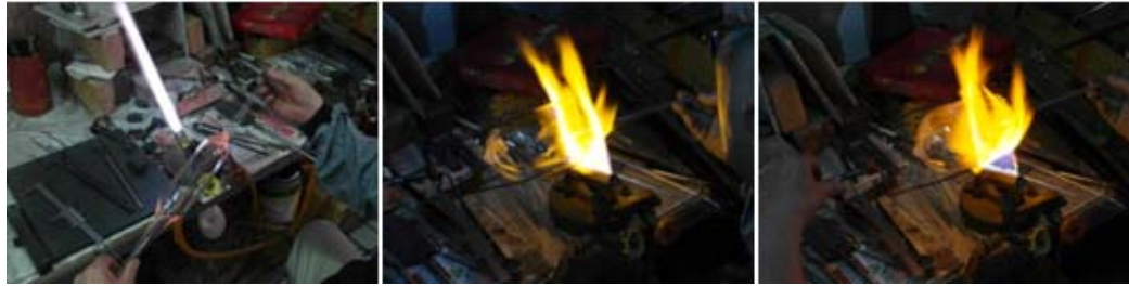
圖 3 -19 雙層玻璃杯製作過程-內層(本創作拍攝)
