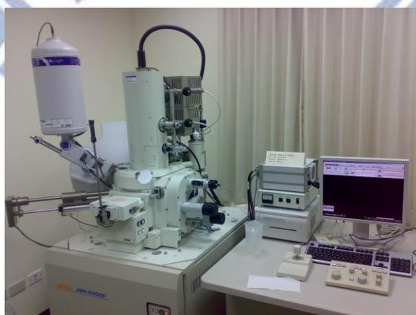
圖 3.12 場發射電子顯微鏡外觀圖
