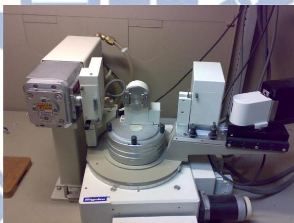
圖 3.10 XRD 繞射儀外觀圖
