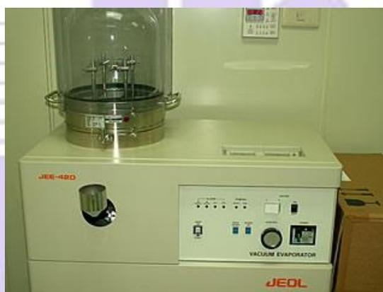
圖 3-1 熱阻絲蒸鍍機
