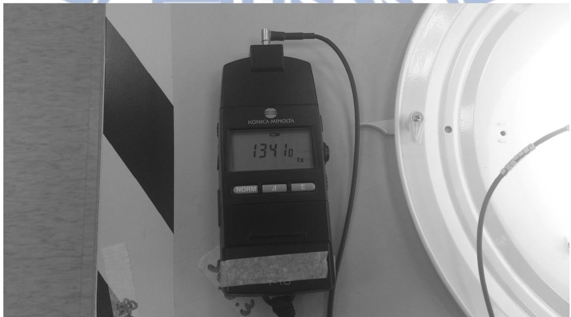
圖 4-9. 照明系統實驗樣品之照度量測儀器 (T-10)
