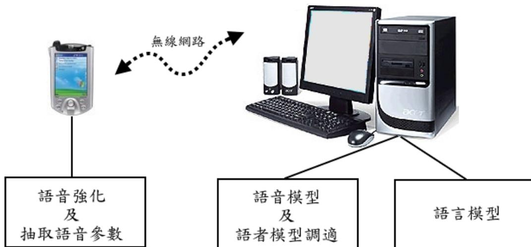
圖 5-1: 分散式語音辨識系統架構圖
