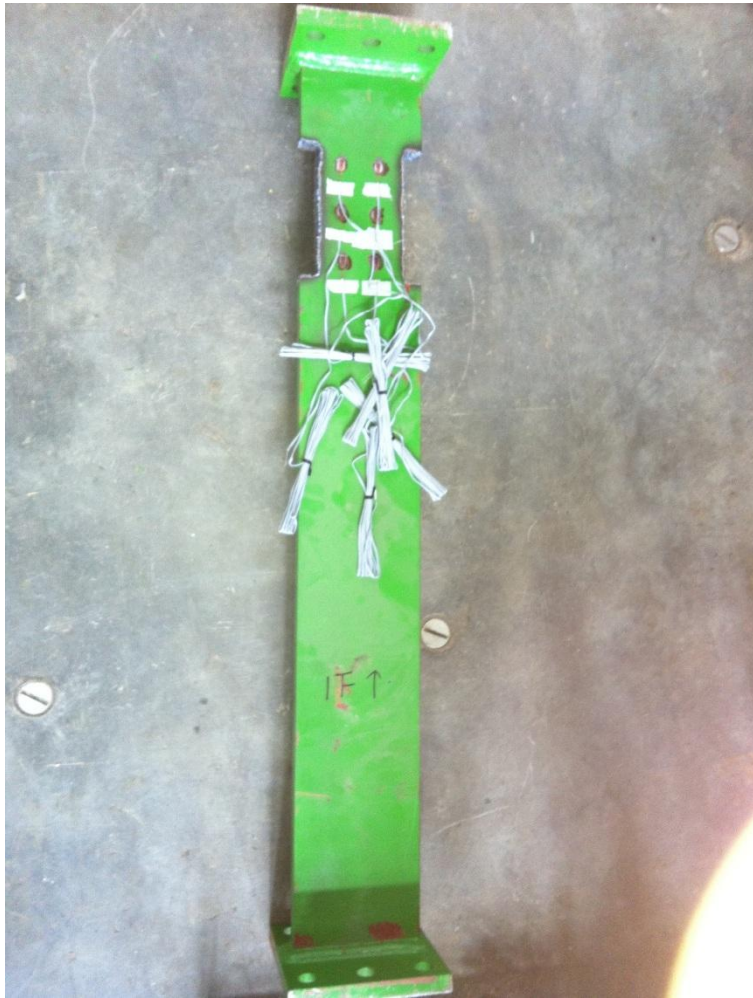
圖 4.3：經切削處理之鋼板支柱
