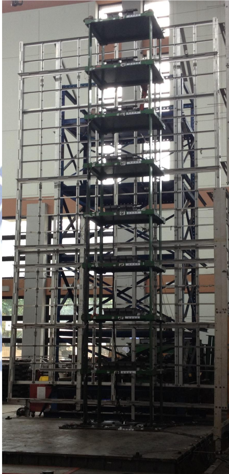
圖 4.1：八層樓鋼構架振動台試驗
