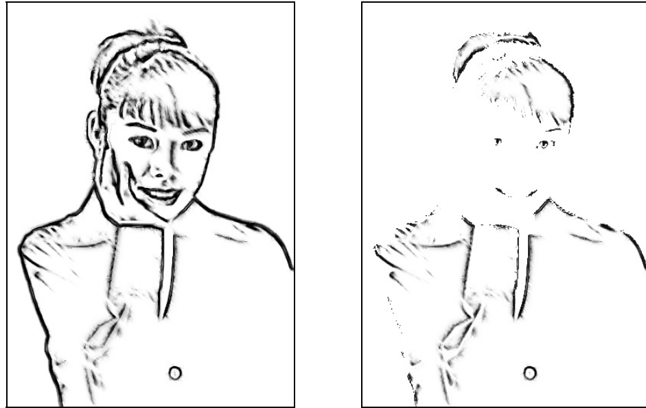
圖 3-7：(A) 圖 3-6 (B) 經亮度強化的輪廓圖 (B) 輪廓結構強化圖
