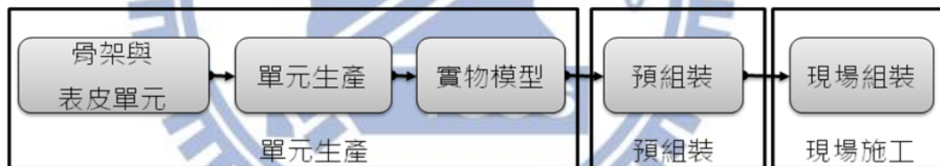
圖 2-22 本研究分析大尺度數位建築設計到建造流程，將原先五個步驟重新歸納為三個步驟：「單元生產」、「預組裝」以及「現場施工」
