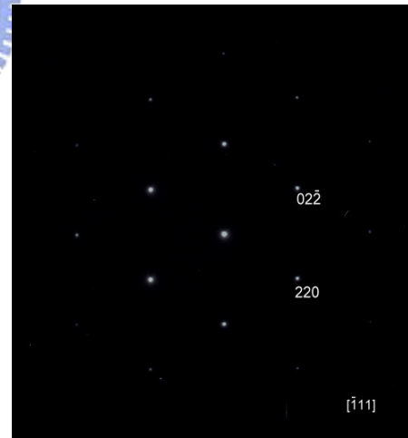
Fig. 4-6 (a) TiN 之明視野像(BFI);(b) TiN 之 EDS 分析光譜; (c)SADP Z=[011];(d)SADP Z=[ \bar{1}11 ]。
