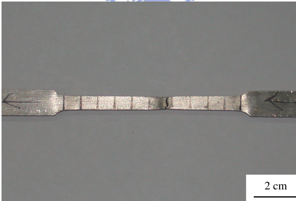
圖 8(b).合金經 550°C 時效 6 小時後拉伸試棒斷裂後的照片。
