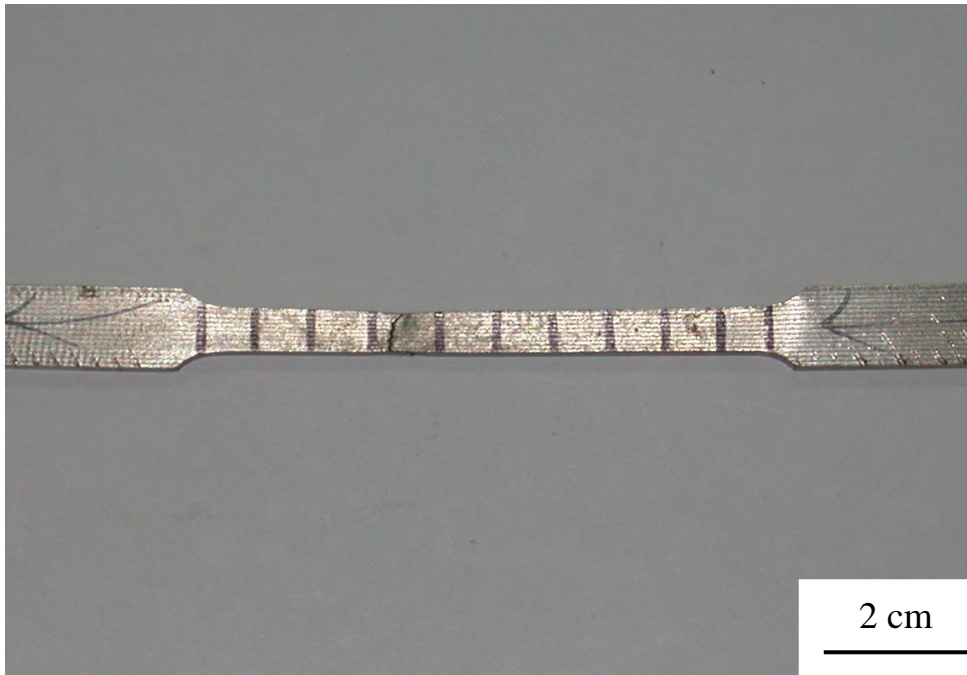
圖 8(c). 合金經 750^{\circ}\text{C} 時效 6 小時後拉伸試棒斷裂後的照片。
