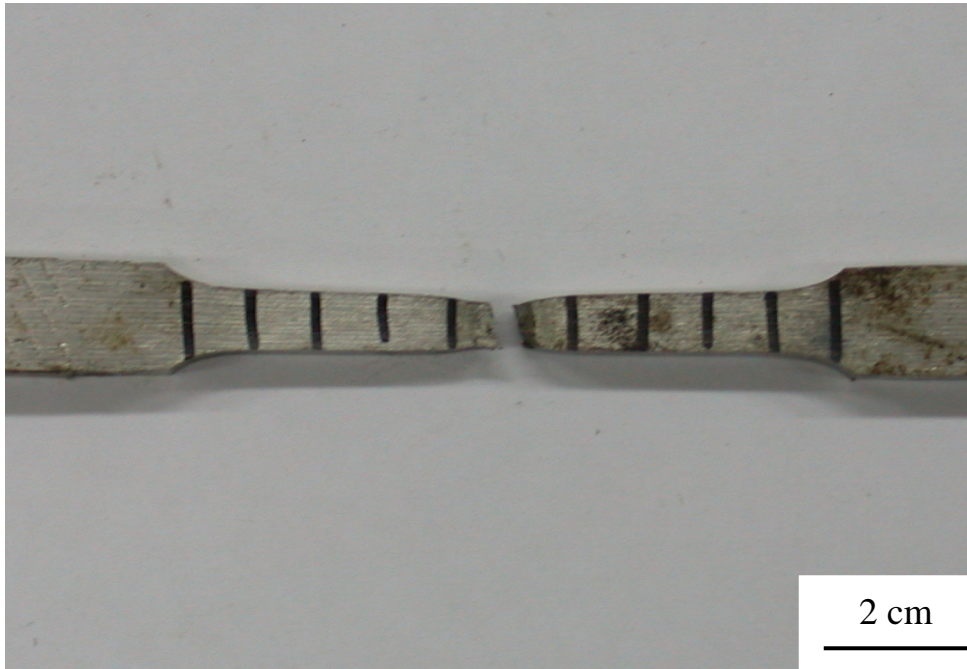
圖 8(a).合金經固溶化熱處理後拉伸試棒斷裂後的照片。
