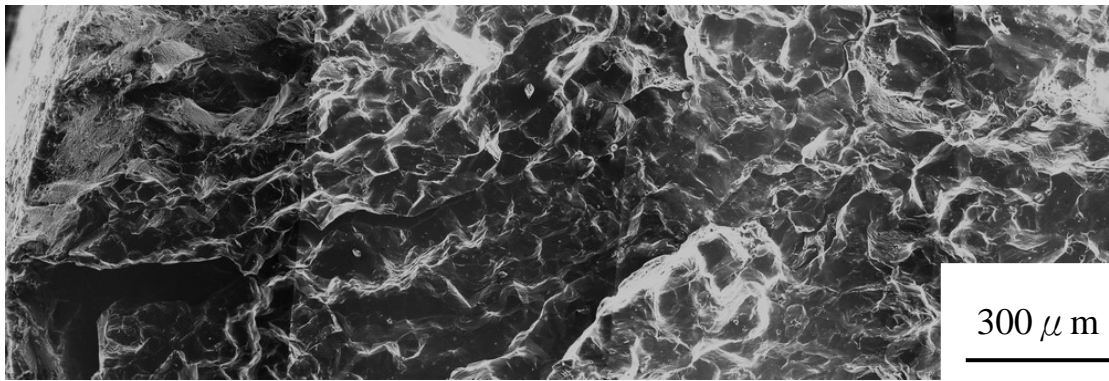
圖 12(a).經過 850°C、6 小時時效處理合金經拉伸斷裂後破斷 橫截面的 SEM 照片。
