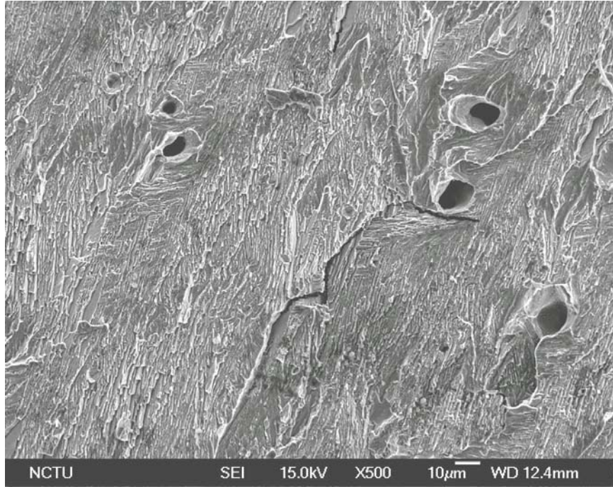
圖 29 7Al-6.5Cr 合金經拉伸試驗後破斷面之 SEM 照片
