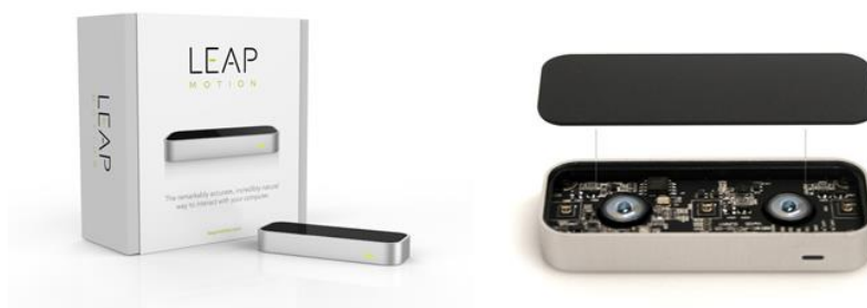
圖 56 Leap Motion 體感儀器及其內部結構圖
