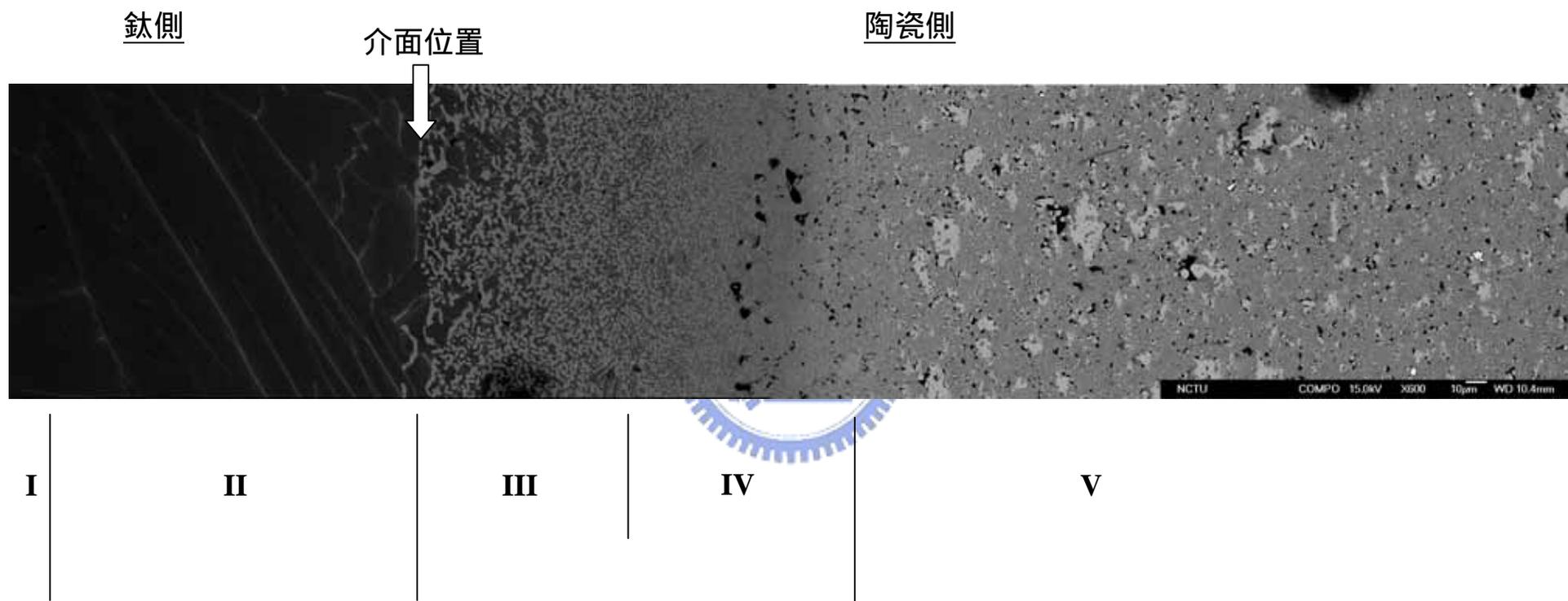
Fig. 4-15 Ti 與 30Y/70Z 1700°C/10min 熔融擴散反應後之介面微觀結構圖 (BEI), 界面位於反應層 II、III 之間。
