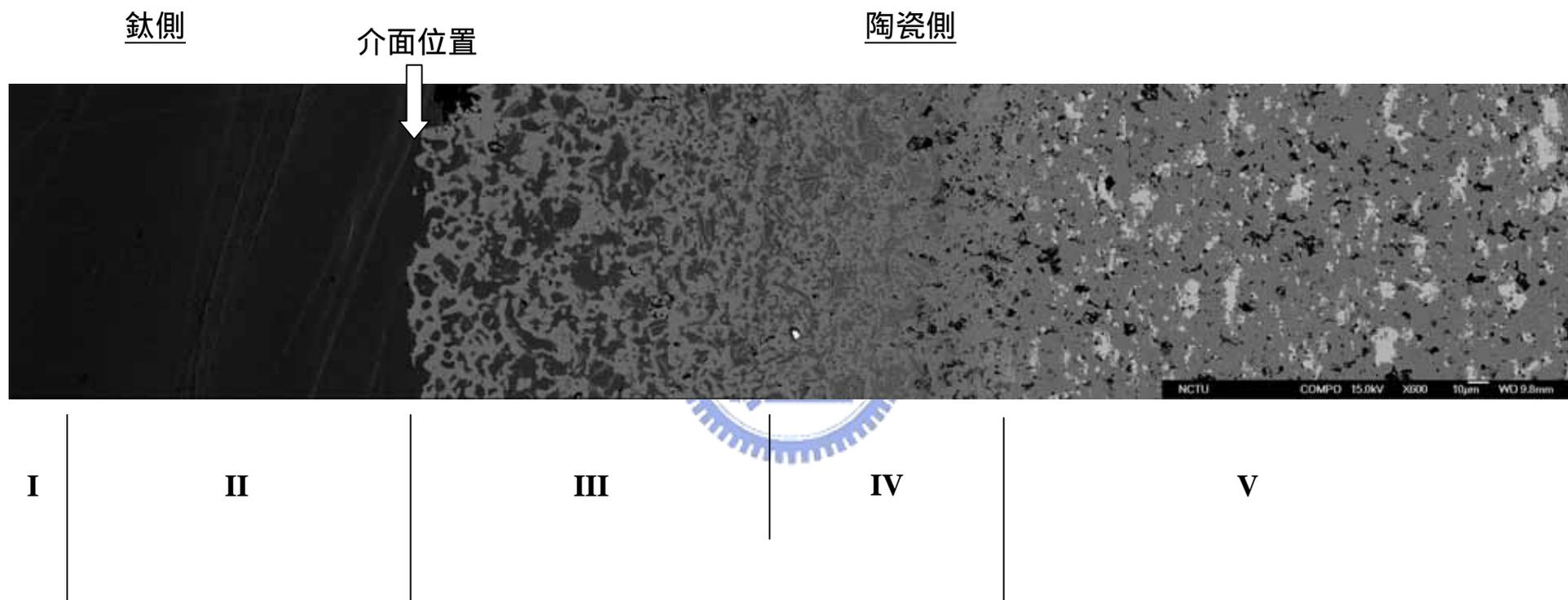
Fig. 4-25 Ti 與 50Y/50Z 1700°C/10min 融熔擴散反應後之介面微觀結構圖 (BEI), 介面位於反應層 II、III 之間。
