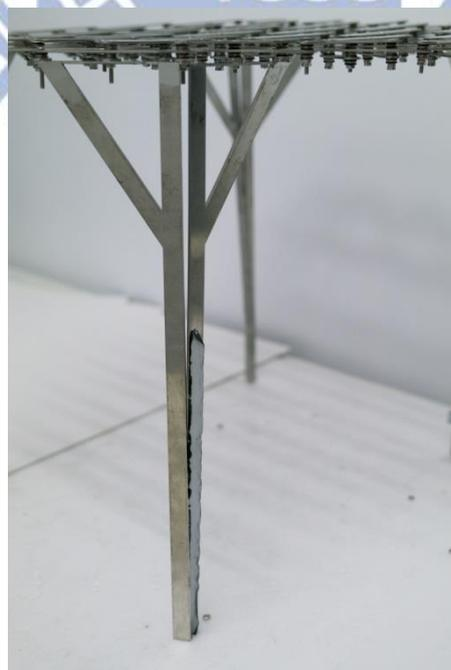
圖 5.42 焊接導致的變形
