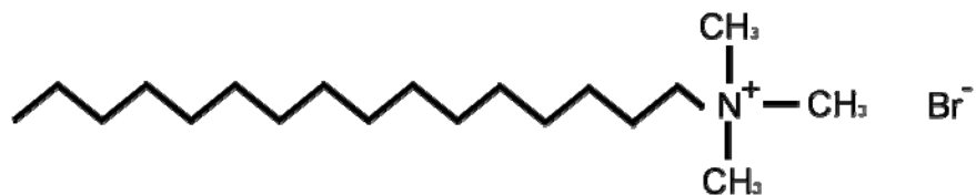
圖 2.6 Cetyltrimethylammonium bromide。簡稱CTABr，其為陽離子型界面活性劑，化學式為 \text{CH}_3(\text{CH}_2)_{15}\text{N}^+(\text{CH}_3)_3\text{Br}^- 。
