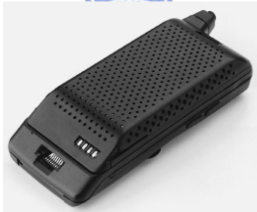
圖 1-3 Motorola MicroTac 之鋅空氣燃料電池行動電話【3】
