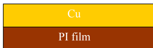
圖 2-1-2、二層結構的聚亞醯胺軟板
