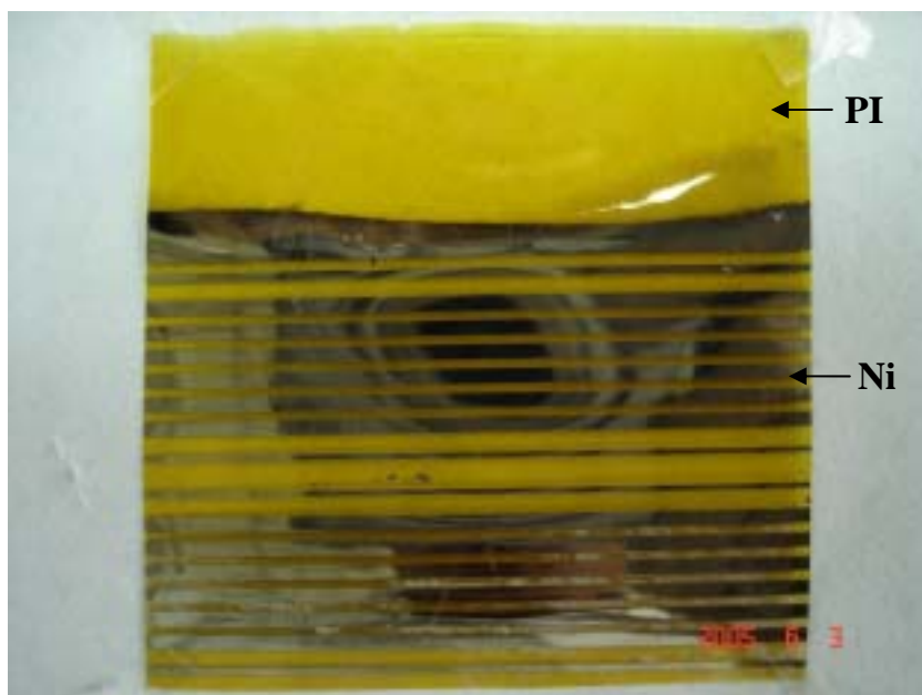
圖 5-8.1、聚亞醯胺表面 Ni 金屬化線路。
