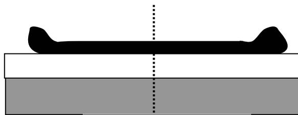
2. 在 10 秒 1000 轉的低轉速下，將 PAA/Ta(OEt)<sub>4</sub> 溶膠溶液均勻散開
