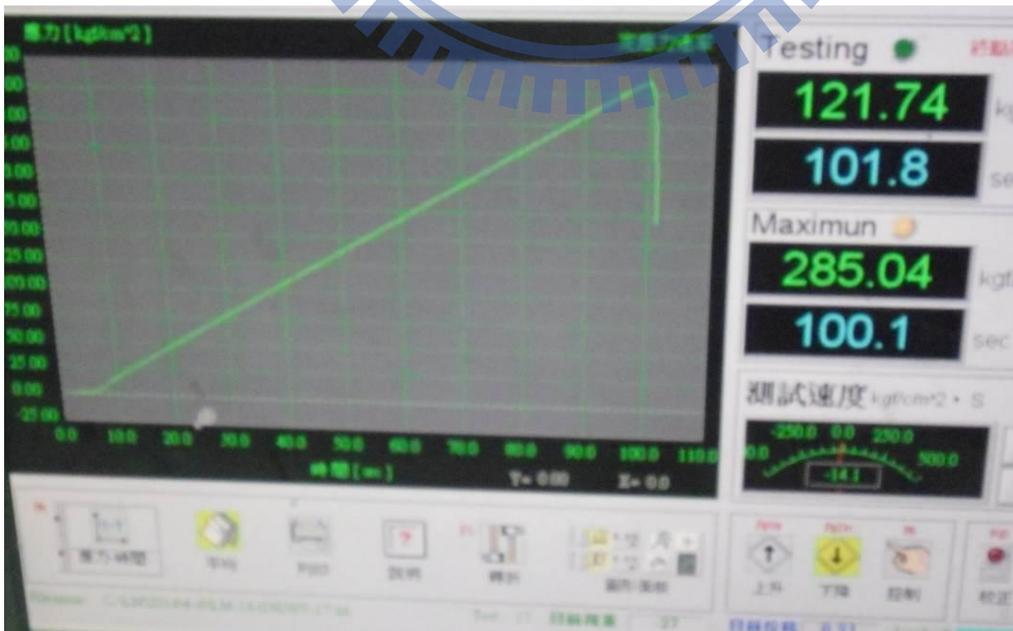
圖 4.3 實驗室  $210\text{kgf/cm}^2$  混凝土單壓試驗
