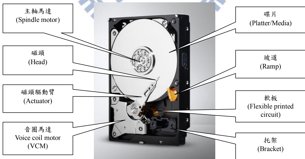
圖 2.1 硬碟內部結構圖
