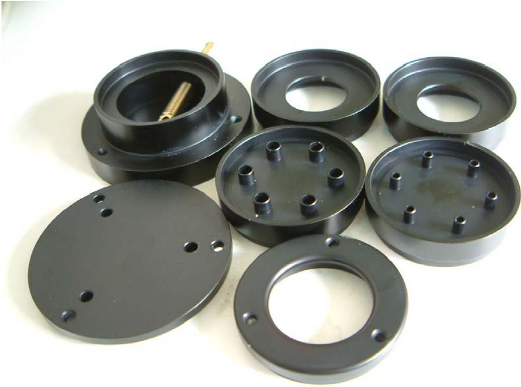
圖 12. 三階粒狀污染物採樣器各部的分解圖。
