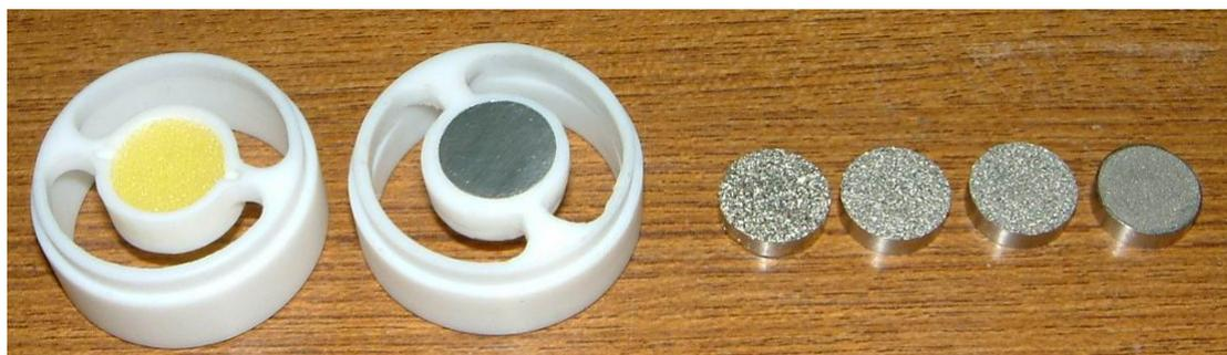
圖 23 不同材質的收集板，由左至右依次為泡綿(65 ppi 或 100 ppi)、鋁箔、100  $\mu\text{m}$ 、40  $\mu\text{m}$ 、20  $\mu\text{m}$  和 5  $\mu\text{m}$  的多孔金屬片。
