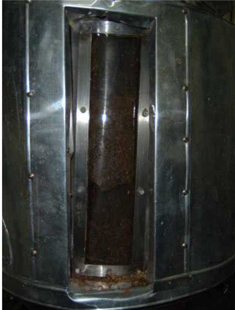
圖 3-2. 反應槽側邊透明壓克力板
