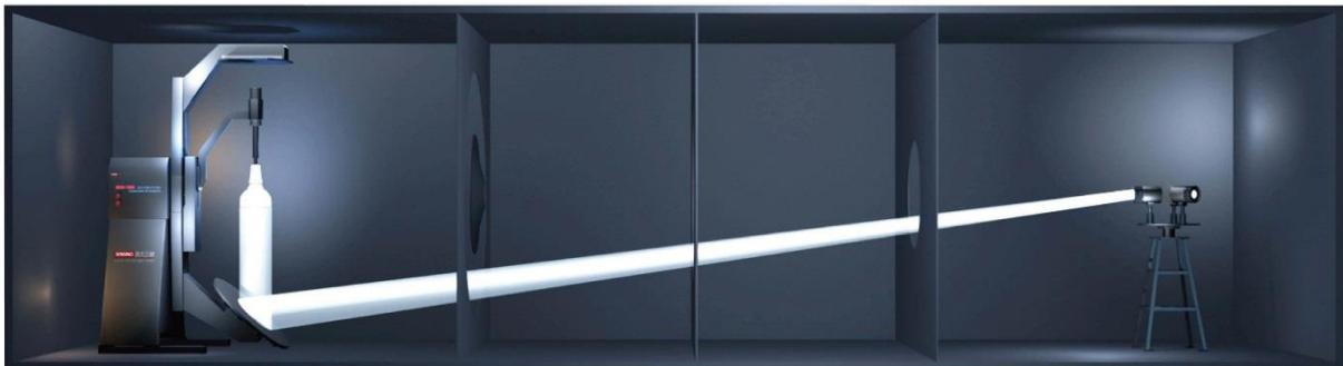
圖 3.1.11 圓周運動反光鏡式測角光度計測試系統圖例
