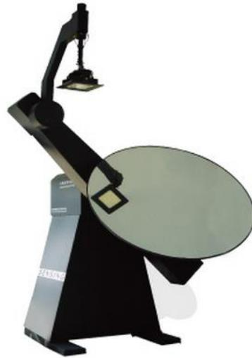
圖 3.1.5 中心旋轉反光鏡式測角光度計
