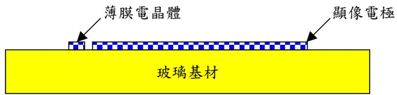
圖 2 陣列製程中單個像素薄膜電晶體的結構示意圖
