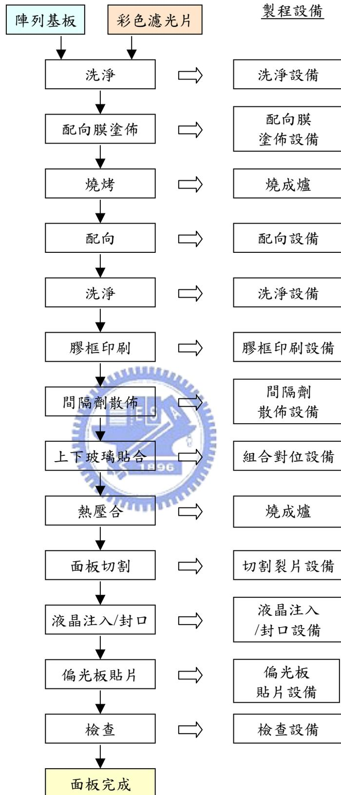
圖 4 液晶顯示器的液晶製造流程
