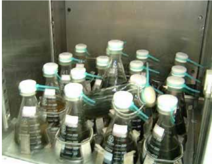
圖 3-8 混合實驗批次式反應槽恆溫震盪
