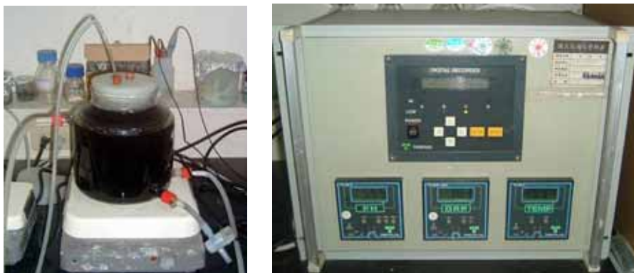
圖 3-2 厭氧污泥馴養槽及 pH, ORP, 溫度偵測器
