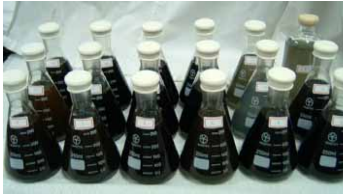
圖 3-6 植入厭氧濃縮污泥後的混合實驗批次式反應槽
