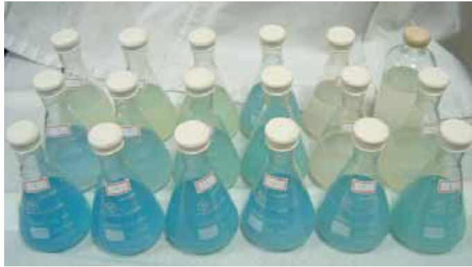
圖 3-5 加入不同重金屬濃度的混合實驗批次式反應槽
