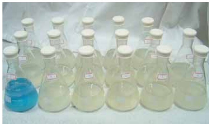
圖 3-4 裝入培養基的混合實驗批次式反應槽
