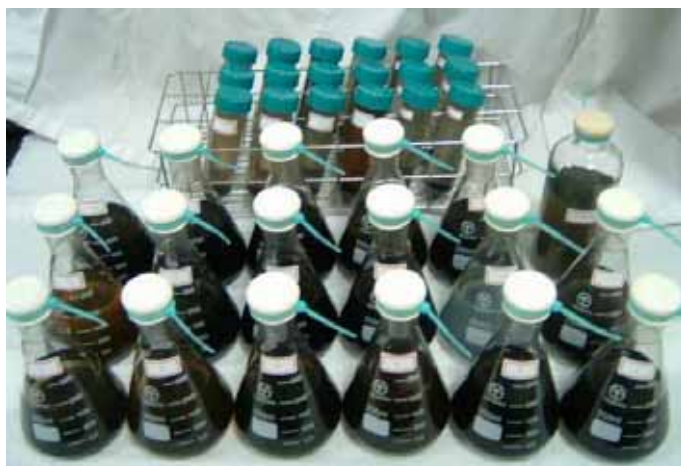
圖 3-7 反應時間 t = 0 hr 採樣後的混合實驗批次式反應槽
