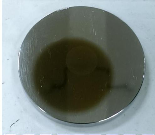
圖 3.3  $\phi 60\text{mm}$  不鏽鋼 DLC 鍍膜模具
