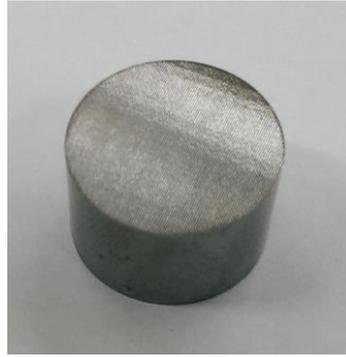
圖 2.18 碳化鎢圓柱上表面微結構
