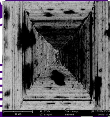
圖 2.25 鑽石精密磨削加工瑕疵微結構 SEM 圖
