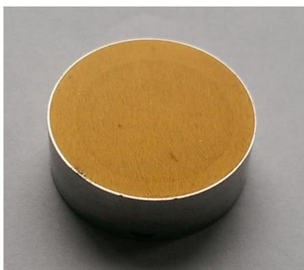
圖 3.1  $\phi 20\text{mm}$  不鏽鋼 DLC 鍍膜模具
