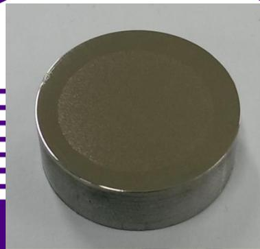
圖 2.39  $\phi 20\text{mm}$  不鏽鋼翻模成果
