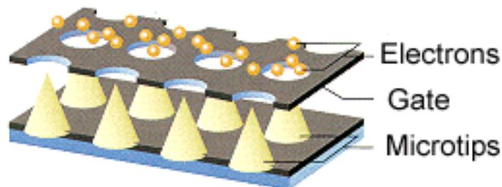
圖 1.4 Spindt 型場發射源[5]
