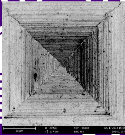
圖 2.21 鑽石精密磨削加工微結構 SEM 圖
